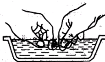
Рис. 21 Промойте корпус форсунки и игольчатый клапан
