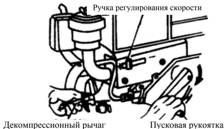
Рис. 11 Запуск двигателя при помощи ручной пусковой рукоятки
