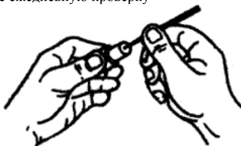
Рис. Удалите нагар с корпуса форсунки
