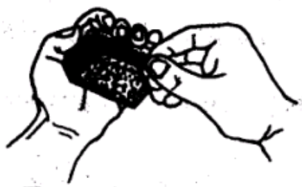
Рис. 20 Удалите нагар с игольчатого клапана
